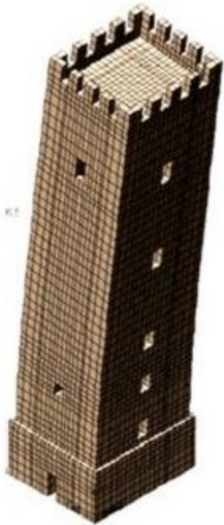
Primo periodo lungo X: 0.500 sec (2.00 Hz)
