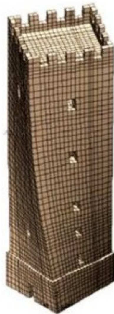
Primo periodo tor- sionale: 0.149 sec (6.71 Hz)
