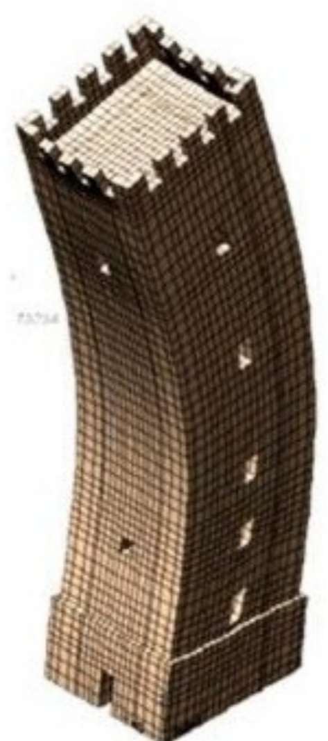
Secondo periodo lungo Y: 0.111 sec (9.01 Hz)
