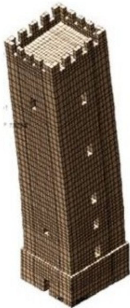
Primo periodo lungo Y: 0.460 sec (2.17 Hz)
