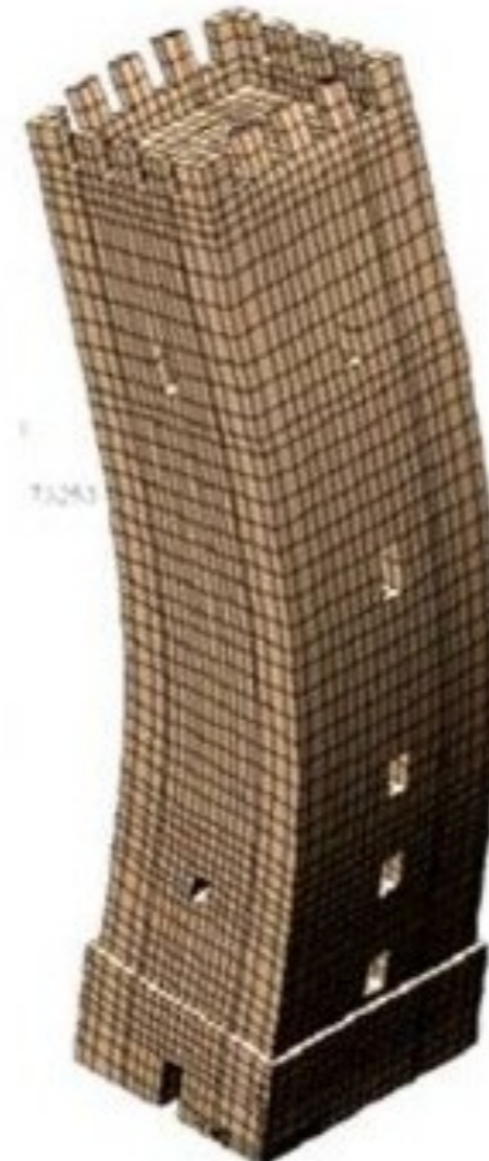
Secondo periodo lungo X: 0.117 sec (8.55 Hz)
