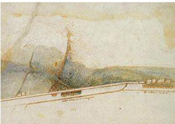
WINDSOR RL 12680, ROYAL COLLECTION TRUST Figura 2. Illustrazione a inchiostro e acquarello del vortice che si forma a valle di una apertura eccentrica in un fiume, forse l'Arno, con effetti di erosione sul molo
